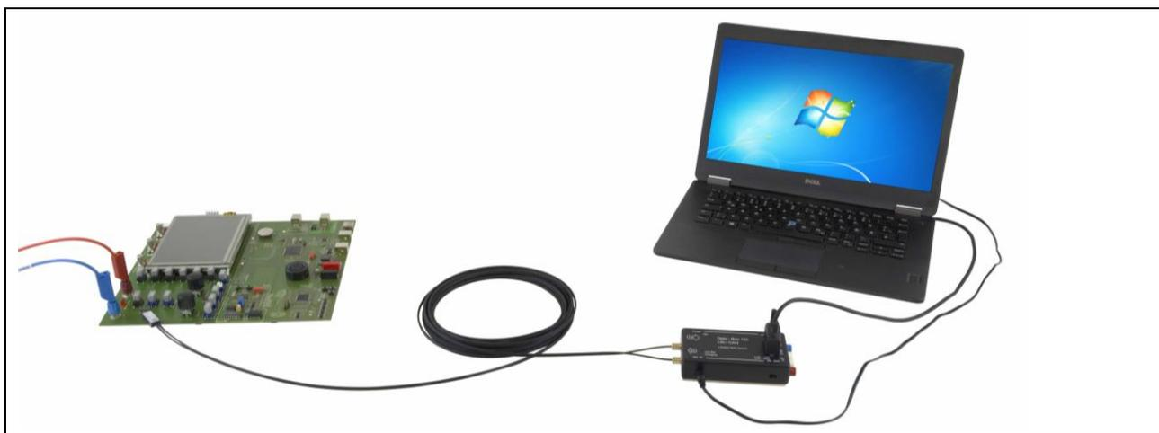
Bild 7: Ein Sensor mit einer Opto-Box zur Datenübertragung ohne LIN/CAN-Bus-Kabel
