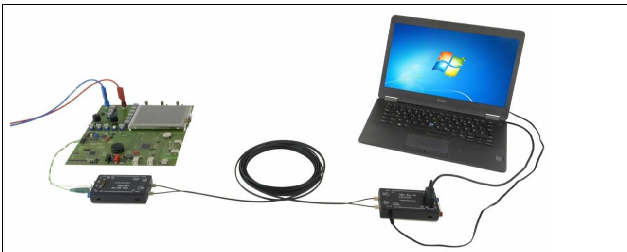
Bild 5: Zwei Opto-Boxen zur Datenübertragung über LWL verbunden
