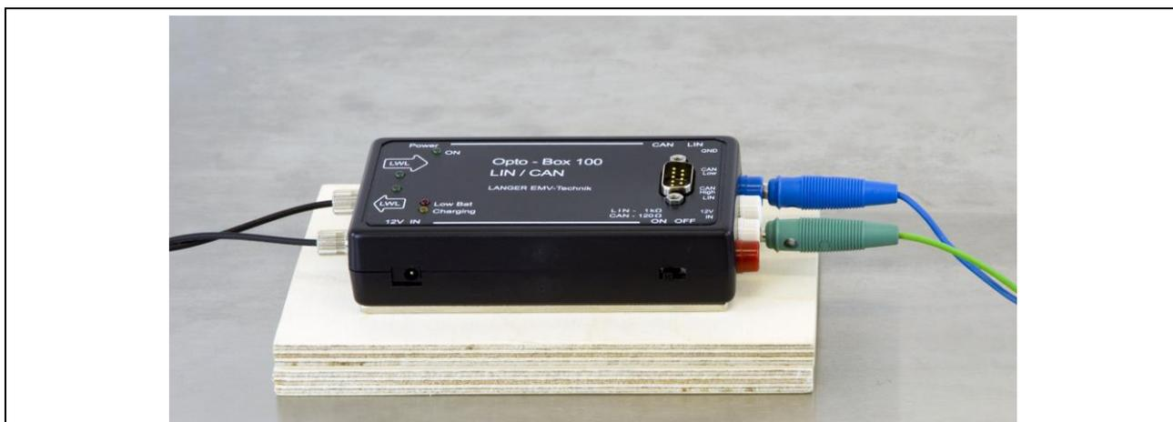
Bild 6: Opto-Box isoliert betrieben
